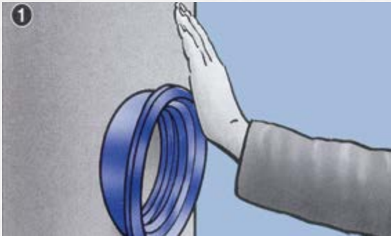
1. Втисніть ушільнювач в отвір. Не використовуйте змаску.
