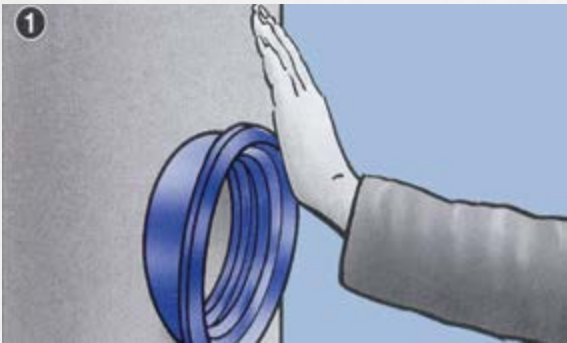
1. Втисніть ушільнювач в отвір. Не використовуйте змаску.
