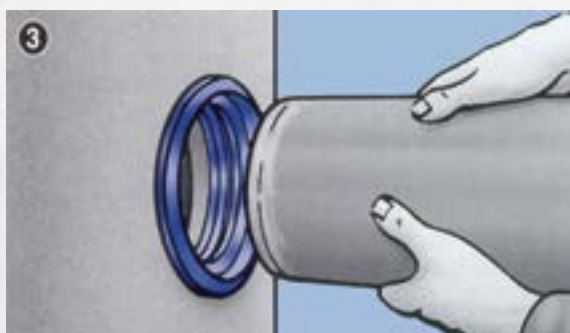
3. Відцентруйте кінець труби і вставте його в ушільнення, кінець труби повинен бути врівень з внутрішньою стінкою.
