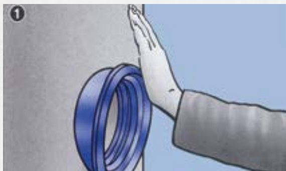
1. Втисніть ушільнювач в отвір. Не використовуйте змаску.
