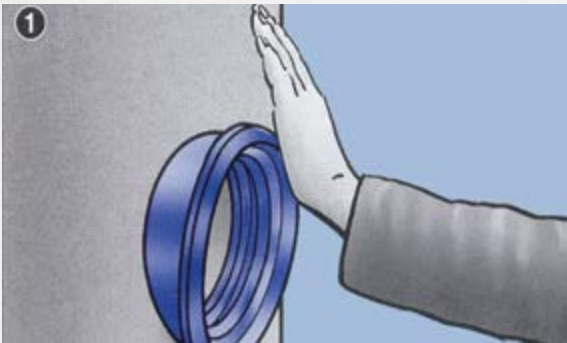
1. Втисніть ушільнювач в отвір. Не використовуйте змаску.
