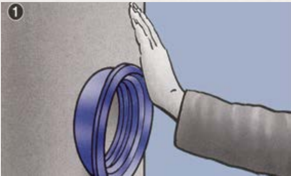
1. Втисніть ушільнювач в отвір. Не використовуйте змаску.
