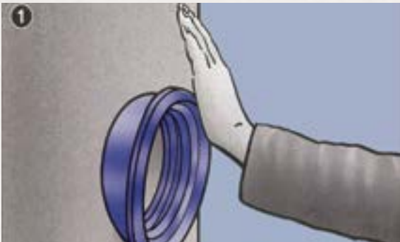
1. Втисніть ушільнювач в отвір. Не використовуйте змаску.
