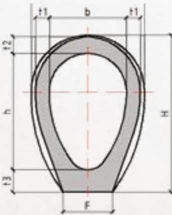
Порівняльна характеристика труби круглого перерізу та труби Qmax.
