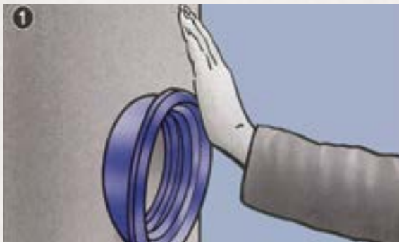
1. Втисніть ушільнювач в отвір. Не використовуйте змаску.
