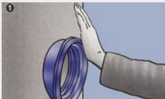
1. Втисніть ушільнювач в отвір. Не використовуйте змаску.
