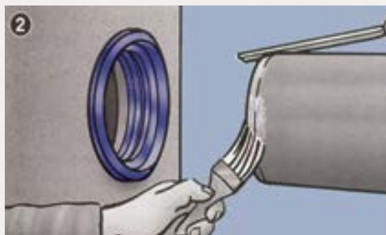
2. Зніміть фаску з кромки сполучної труби і змастіть її змазкою
