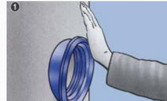
1. Втисніть ушлінювач в отвір. Не використовуйте змаску.
