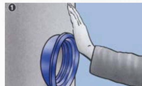
1. Втисніть ущільнювач в отвір. Не використовуйте змаску.
