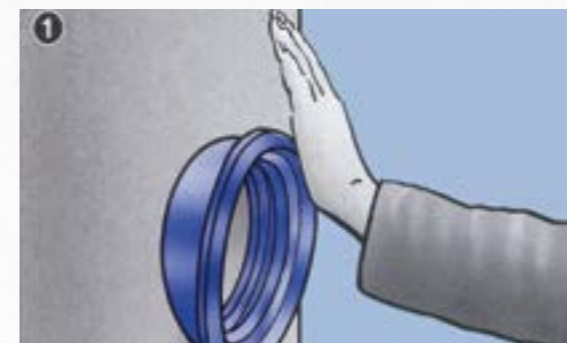
1. Втисніть ущільнювач в отвір. Не використовуйте змаску.
