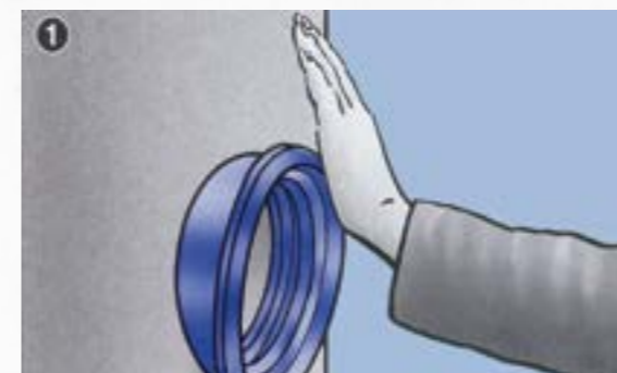
1. Втисніть ущільнювач в отвір. Не використовуйте змаску.
