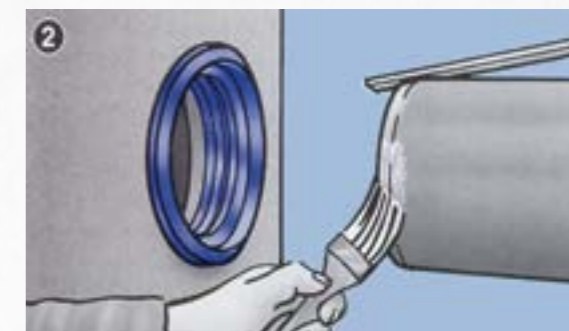
2. Зніміть фаску з кромки сполучної труби і змастіть її змазкою
