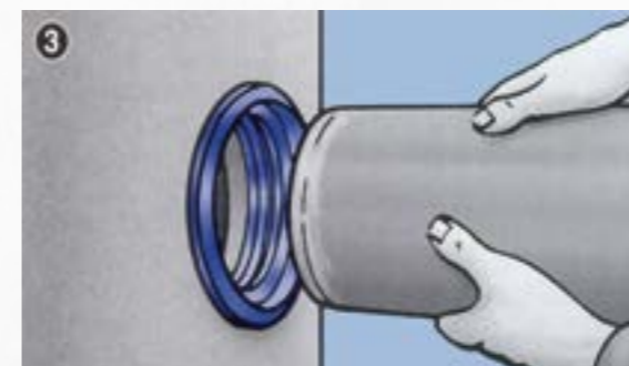
3. Відцентруйте кінець труби і вставте його в ущільнення, кінець труби повинен бути врівень з внутрішньою стінкою..
